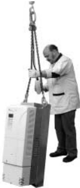
*Heben eines Geräts der Baugröße R6*
