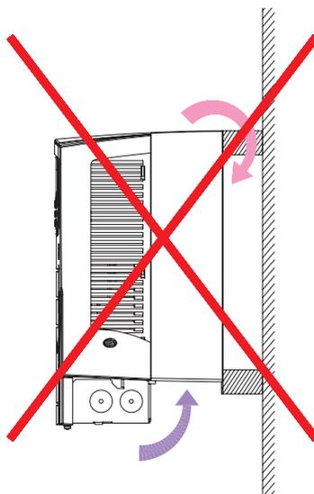
In der folgenden Abbildung sind die Mindestabstände für die Kühlung angegeben. Die erhitzte Kühlluft eines Frequenzumrichters darf nicht von einem anderen Frequenzumrichter angesaugt werden.
